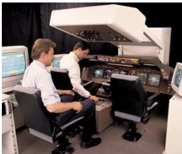
Più completo e sofisticato è invece il Full Flight Simulator, per la cui qualifica secondo il regolamento JAR-STD 1A è necessaria l'installazione su tutti i livelli sia del Visual System che del Motion.
