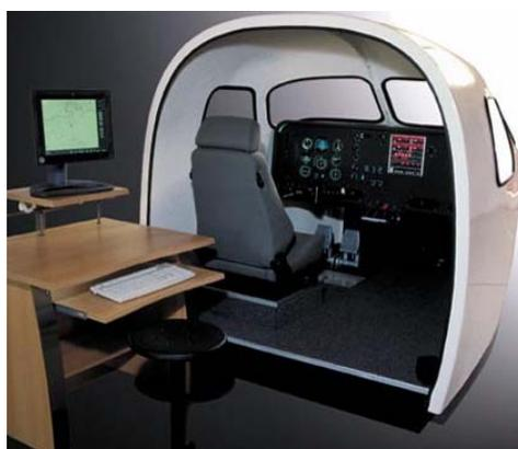
Per quanto riguarda gli FTD, essi vengono progettati e realizzati per riprodurre fedelmente tutta la strumentazione (avionica, pannelli, pulsanti, indicatori, leve, monitor, ecc.) presente generalmente all'interno della cabina di pilotaggio (*flight deck*) di un aeromobile (in taluni casi di uno specifico aeromobile), che, opportunamente guidata da un sistema computerizzato, fornisce risposte realistiche agli input del pilota in addestramento.
